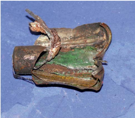
Explodierte Zelle eines Lithium-Ionen-Ak- kus Foto: IFS
